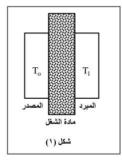
ولما كانت عملية نزع الحرارة من جسم عن طريق ملامسته لجسم آخر درجة حرارته أقل لا ينتج عنها شغل ميكانيكي إذن أفضل طريقة للحصول على شغل ميكانيكي أثناء انتقال الحرارة من المصدر إلى المبرد هي أن يتم انتقال الحرارة من المصدر إلي مادة الشغل ثم انتقال الحرارة من مادة الشغل إلي المبرد بدون فارق بين درجتي حرارتهما. معنى
