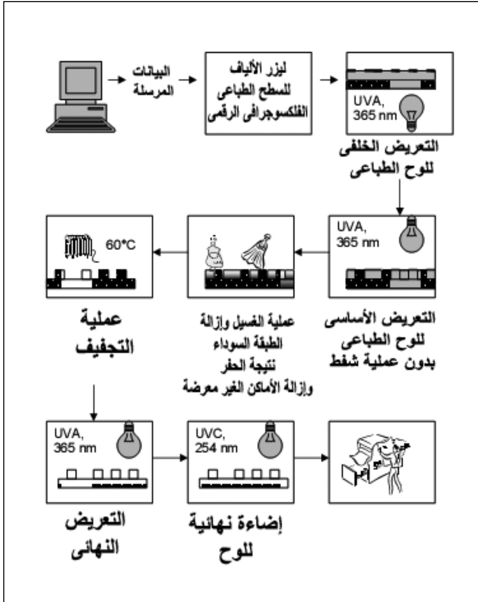
شكل يوضح المراحل التشغيلية للألواح الفلكسوجرافية الرقمية
