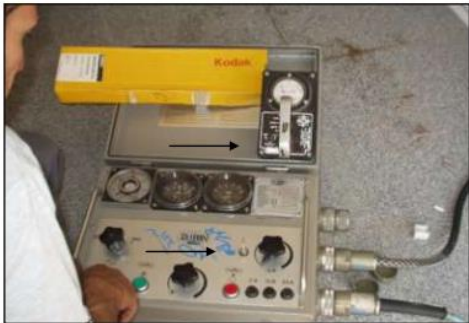
صورة توضح جهاز التصوير بالأشعة السينية وتبين افلام التصوير وعداد جيجر المستخدم لقياس الاشعاع
