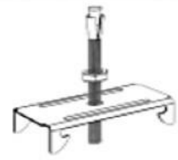
وحدة تركيب التيش في السقف باستخدام أكمون.
