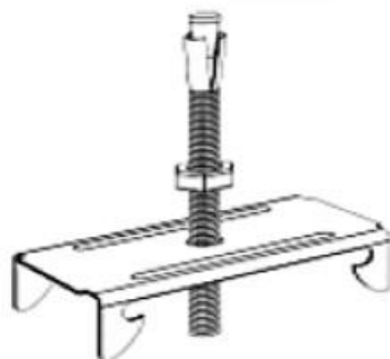
تركيب التيش الصلب في السقف.
