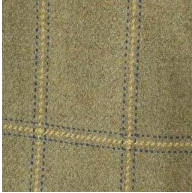
شكل (٢٥) استخدام الخيوط ذات المناطق السميفة في السداء واللحمة لإنتاج أقمشة التويد tweed
